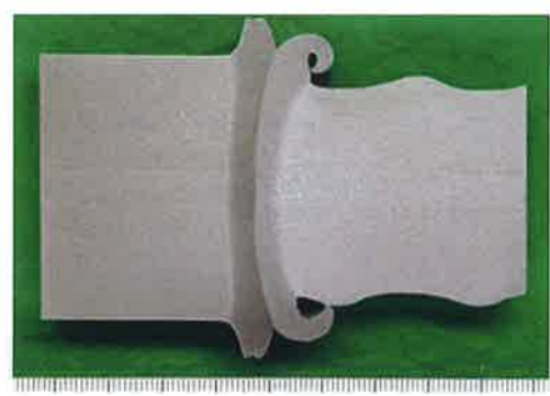
鉄筋・棒鋼摩擦圧接継手部の断面マクロ組織
