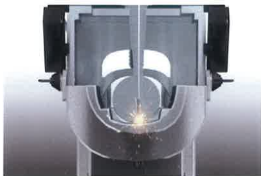
溶接治具、棒鋼および溶接トーチ相関
