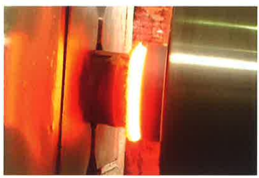
「鉄筋と棒鋼」の摩擦圧接状況
